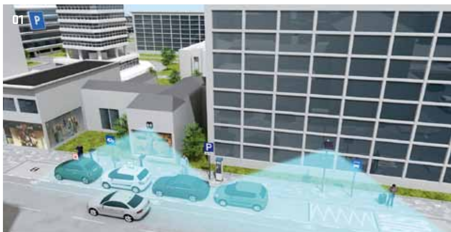
01 > Radarové senzory předávají informaci o obsazenosti do kontrolního střediska
